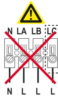
Bei *gleichzeitiger* Verwendung zweier Wicklungen (z.B. LA + LB) bzw. Anschluss des Schutzleiters (PE) an einer der Klemmen LA oder LB werden die Motorwicklungen thermisch überlastet.
